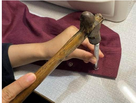
Gambar 9. Pemasangan eyelet (Dokumentasi: Faizanisa Ulaya, 2026)
